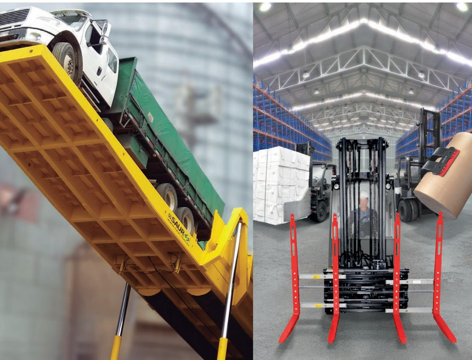
A partir de 2022, os clientes da SAUR têm acesso à primeira plataforma de descarga para granéis de 30 metros com balança. O equipamento é indicado para operações intensas de fluxos prolongados em portos e centrais de recebimento
