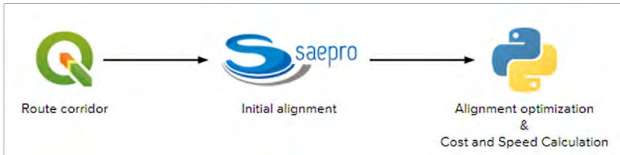
Figura 50 - Fluxograma para obtenção do Alinhamento HyperloopTT
